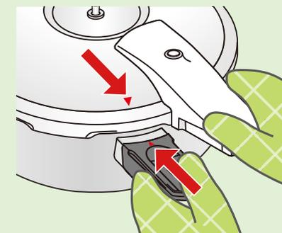
圧力が下がると内圧表示ピンが下がるので、下がったことを確認してから、オモリを手前に傾けて蒸気が全て抜けたことを確認します。オモリが熱くなっている場合、布きんなどを使って拭き取ってください。オモリを抜き取った後、把手をまわして蓋を開けます。(16・17頁蓋の開け方参照)
