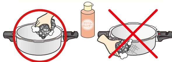
内側の汚れ・焦げつきがしつこくて落ちない場合は、**金属製のタワシ**に**クリームクレンザー**をつけて汚れを落としてください。
