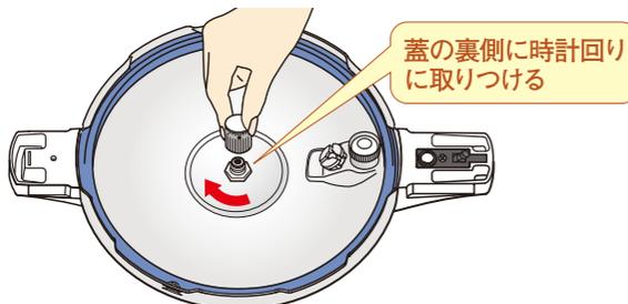
蒸気ノズルカバーを蓋の裏側に時計回りに取りつけます。
