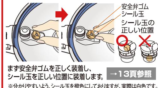
まず安全弁ゴムを正しく装着し、シール玉を正しい位置に装着します。→13頁参照
