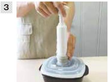
蓋中央の「**真空栓**」を付けたまま、その上から真空ポンプを垂直に当てます。片手で真空ポンプを垂直に固定して、もう一方の手で真空ポンプを上下させて空気を抜きます。通常2~3回で**真空表示ボタン**が凹みますので、そこから更に真空ポンプが重たくなるまで(10~20回位)空気を抜きます。
